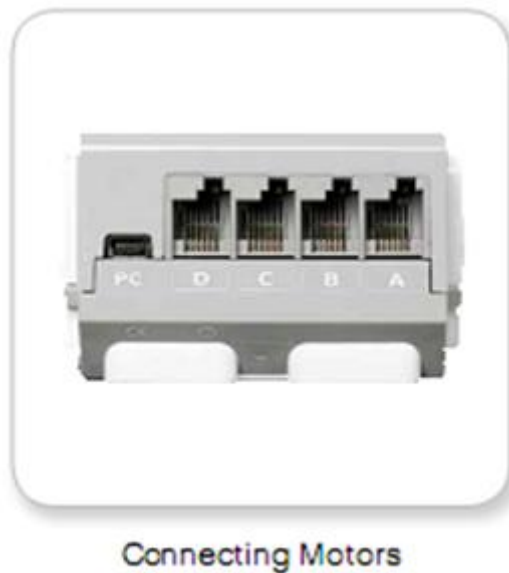
ภาพที่ 3 พอร์ตสำหรับเชื่อมต่อการทำงานกับมอเตอร์
